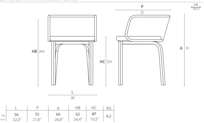
L - largura; P - profundidade ; A - altura; HB - altura de braço; HC - altura do assento // W - width; D - deph; H - height; AH - arm height; SH - seat height
